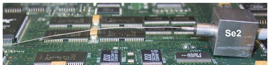
Je nach Löttaufgabe ergeben sich Vorteile für die Messung mit einem der beiden Sensortypen. Für die meisten Reparaturanwendungen ist die Arbeit mit dem berührungslosen Temperatursensor zuverlässiger, da es zu keinen Fehlmessungen aufgrund ungünstiger Wärmeübertragung kommen kann.
