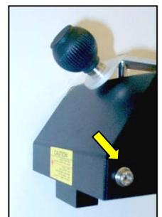
Nach der Justage muss der Laserpunkt die Stelle markieren, an der die Vakuumpipette aufsetzt. (Prüfung durch Einschwenken des Oberstrahlers und Betätigen der Pipette).
