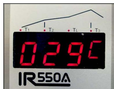
An den Stellen (Digit)1 bis 3 werden die aktuellen Temperaturwerte und die Einstellwerte der Programmparameter angezeigt.
